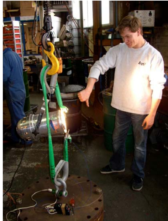
Figuur 4: Rondstrop bezweken door de hitte van de lichtbundel.
